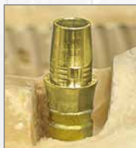
TiBase posizionato sull'analogo nel modello
