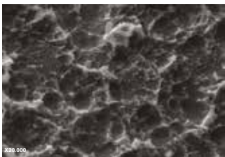
Ingrandimento SEM che evidenziano la microrugosità di superficie
